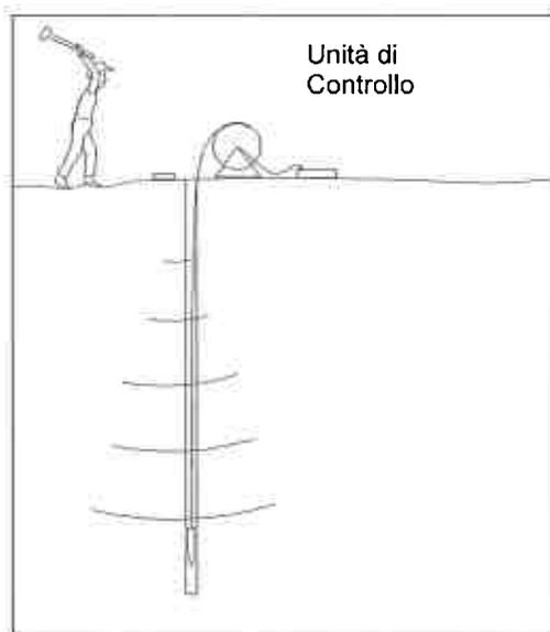
Fig. 1 – Schema del sistema d'acquisizione
